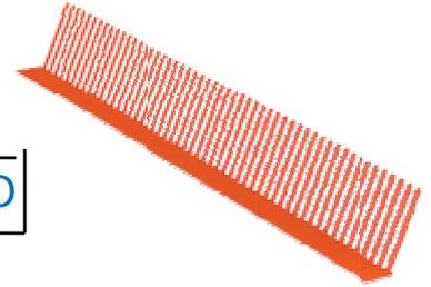
Se coloca en el alero de las cubiertas de teja para evitar la entrada de pájaros, roedores y hojas por debajo de las tejas, permitiendo la libre ventilación de la cámara de aire que se forma entre las tejas y el soporte en una cubierta ventilada.
